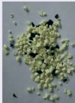
Ergebnisse der Sortierung aus Modell Charge 1 (In einem Produktstrom aus Partikeln werden die Verunreinigungen erkannt und entfernt. Das gewünschte Produkt POM gelb kann als reine Fraktion entnommen werden.) links: Eingangsfraction der Partikelteilchen; rechts: sortierte Fraktion „POM gelb“
