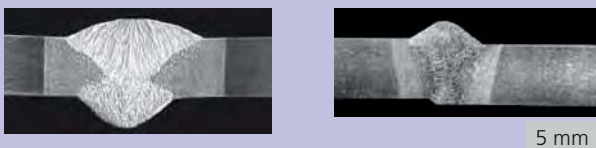
Querschliff und Festigkeitswerte einer MSG/UP-Schweißnaht (links) im Vergleich zu einer Laserhybrid-Schweißverbindung rechts (SZW Union NiMoCr)
