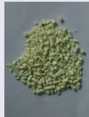
Ergebnisse der Sortierung aus Modell Charge 1 (In einem Produktstrom aus Partikeln werden die Verunreinigungen erkannt und entfernt. Das gewünschte Produkt POM gelb kann als reine Fraktion entnommen werden.) links: Eingangsfraction der Partikelteilchen; rechts: sortierte Fraktion „POM gelb“
