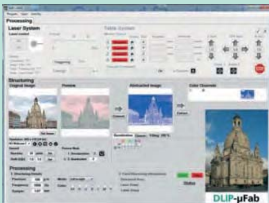
Software-Tool zur DLIP-Anlagensteuerung und Umwandlung von Bitmaps
