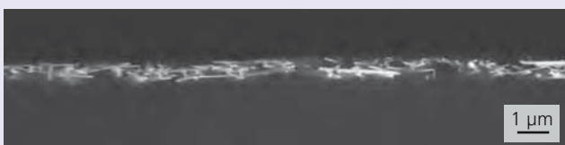
REM-Aufnahme von PET-Folie mit eingelagerten Silber-Nanodrähten
